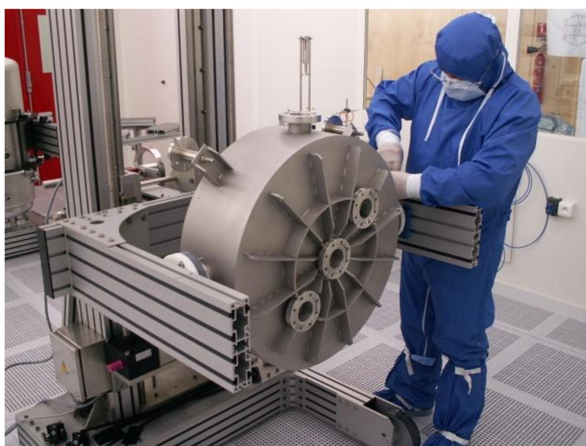
Assemblage d'une cavité de conditionnement de coupleurs
