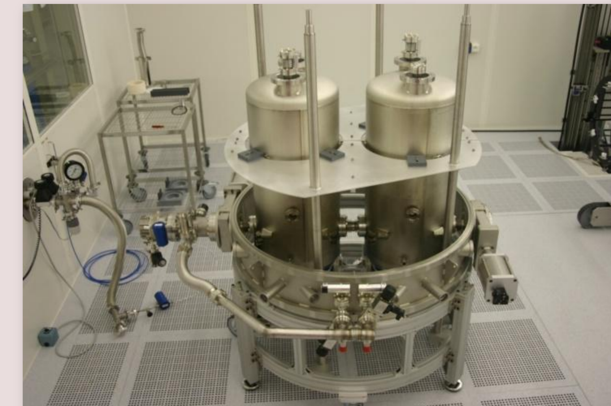
Assemblage de deux cavités Spiral2 dans un crymodule
