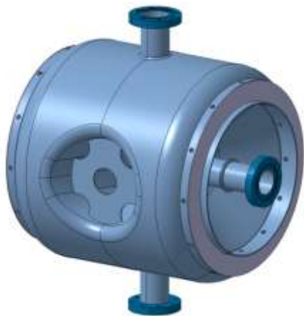
Cavité simple Spoke beta 0.37, f = 352 MHz
