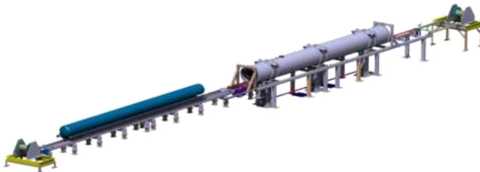
Banc de cryostating (insertion de la masse froide dans l'enceint à vide), S-LHC.
